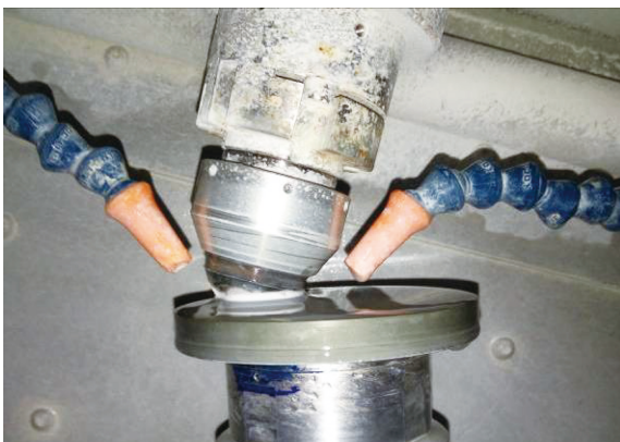
图7 非球面抛光试验
